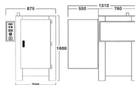
I forni LMFT sono degli asciugatori a circolazione forzata d'aria calda progettati per realizzare dei processi termici fino a 270 °C, garantendo la precisione del setpoint di lavoro ed un'uniformità di temperatura entro tolleranze molto contenute. Diversi sono gli impieghi di utilizzo: la cottura, la reticolazione, l'essiccazione, il rammollimento, l'asciugatura e per completare i cicli di fissaggio per verniciatura.
